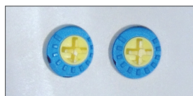
・ オゾン濃度調整ボリューム ・ オゾン風量調整ボリューム
